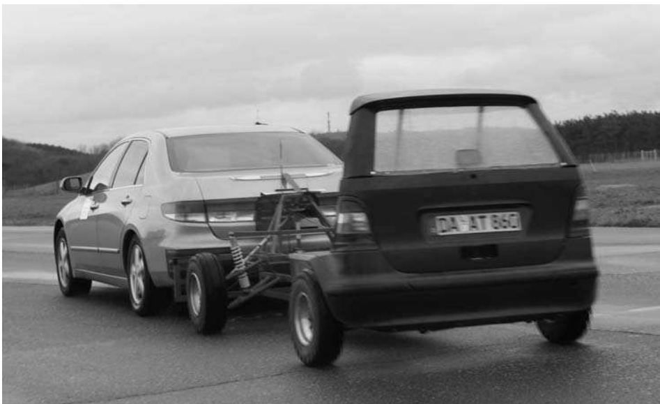
Abbildung 2: EVITA (bestehend aus Zugfahrzeug und dummy target)
