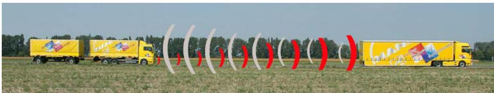
Bild 4: ACC-Radarprinzip (MAN)
