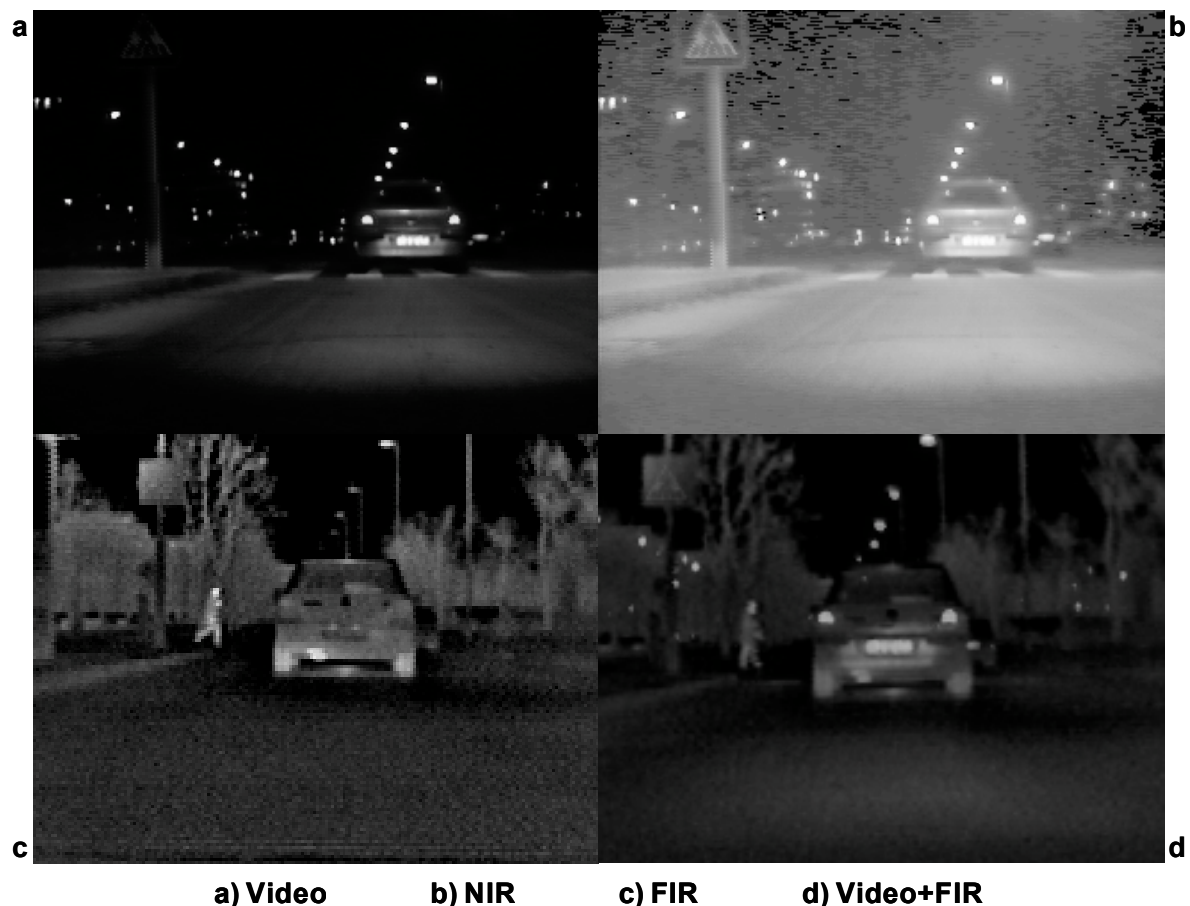
Bild 14 : Sichtverbesserung durch Nightvision-System (NIVI)
