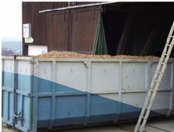
Abbildung 10-4 Container zur Holzhackschnitzeltrocknung
