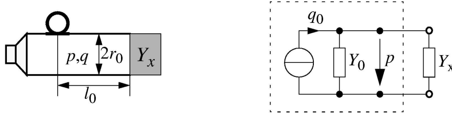
Bild 4.14: Prinzip der kalibrierten Schallquelle und Ersatzschaltbild (Quelle: Lodwig [117, S. 31])
