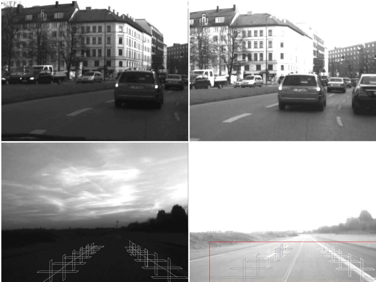
Bild 2: Die Bildpaare entstanden zeitgleich mit zwei baugleichen Kameras, die jeweils rechten Aufnahmen unter Verwendung der adaptiven Belichtungsregelung.
