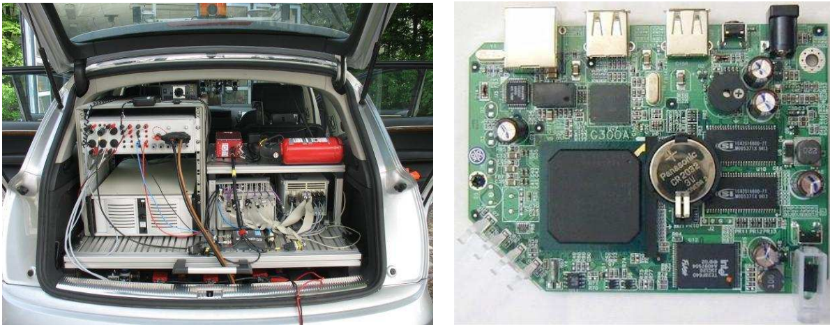
(a) Fahrzeugrechner (l.u.) im Kofferraum des Audi Q7 (b) Eingebettetes System mit ARM-Prozessor
