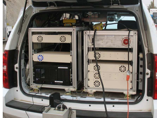
(b) Kofferraum mit Rechnersystem
