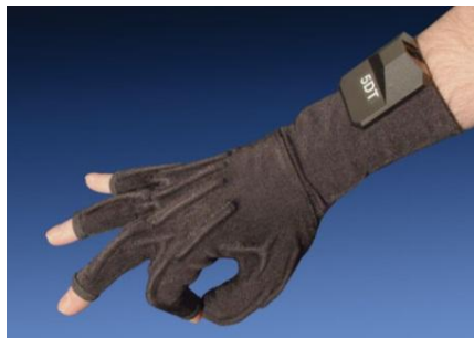
Abbildung 3-16: „DataGlove“ von Fifth Dimension Technologie [Est-2012]
