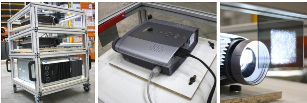
Abbildung 6-3: Projektorenwagen mit Workstation, Beamern und Polarisationsfiltern
