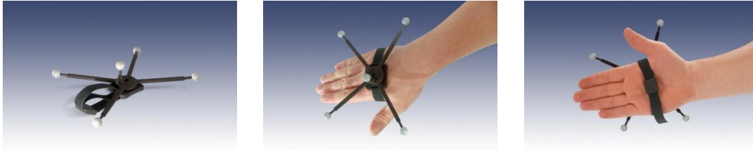
Abbildung 3-17: Realisierung eines Handtrackings [Art-2012]
