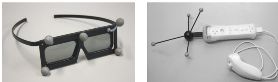
Abbildung 6-15: Trackingtarget der Benutzerbrille und des Wii Controllers
