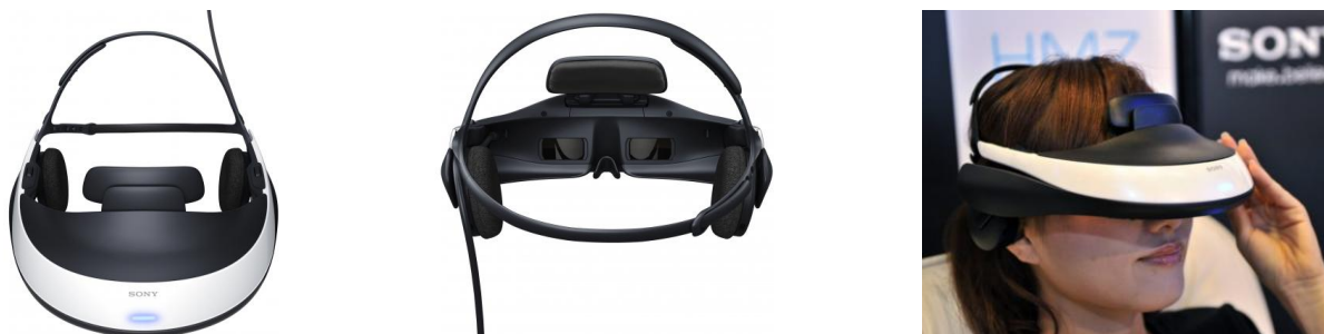
Abbildung 3-6: Head-Mounted Display Sony „HMZ-T1“ [Son-2011]
