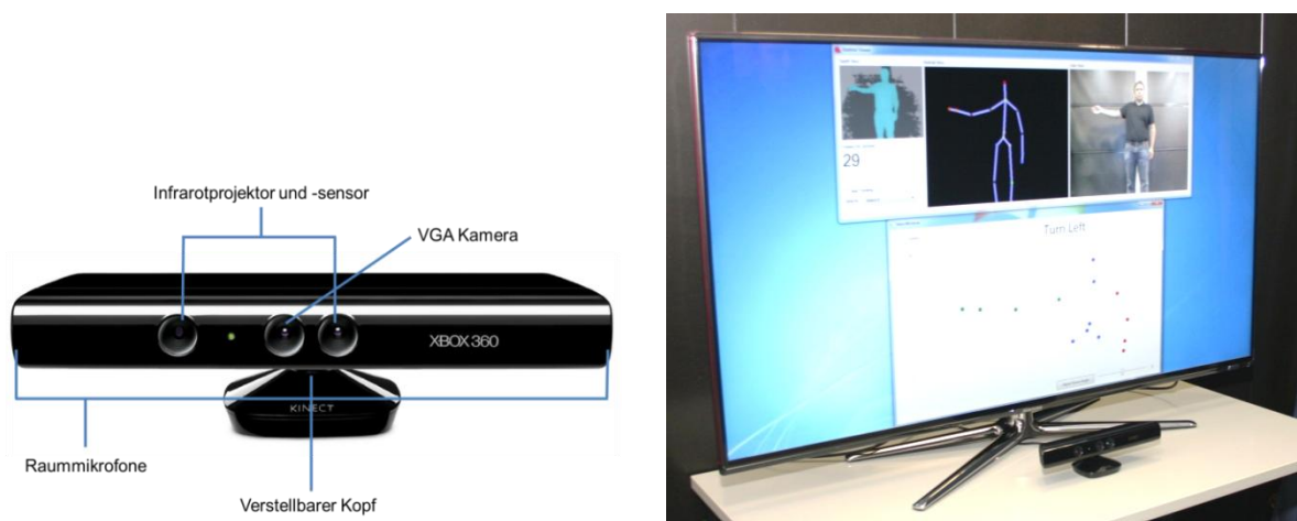
Abbildung 9-1: Aufbau der Microsoft Kinect und Darstellung des Skelettmodells
