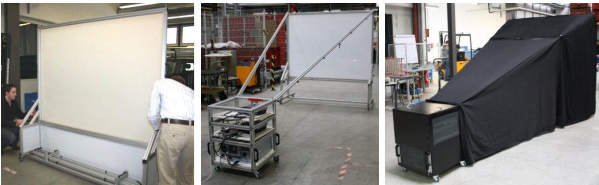
Abbildung 6-4: Aufbau des mobilen VR-Systems ohne und mit Strahlengangverdunkelung
