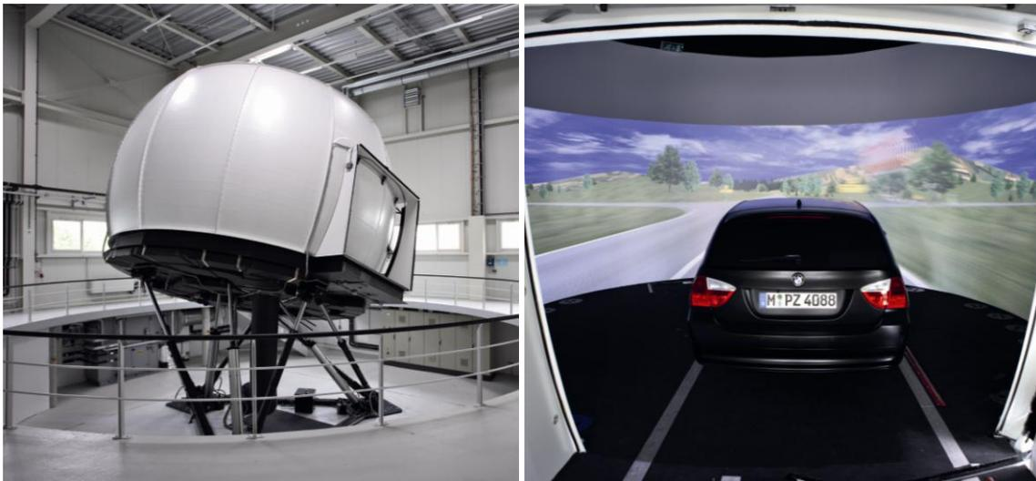
Abbildung 7.1.: Abbildung des dynamischen Fahrsimulators zur Objektivierung der Bewertung des Störungsverhaltens
