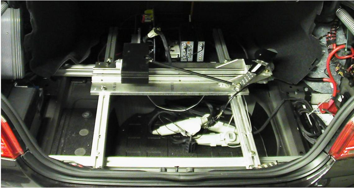
Abbildung 4.8.: Verbaue des Massenpendels im Kofferraum des Versuchsfahrzeugs
