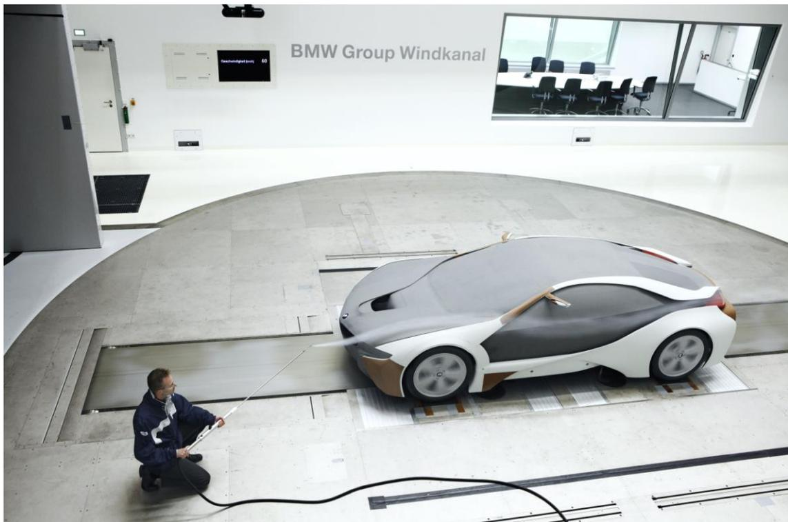
Abbildung 2.6.: Darstellung des aerodynamischen Windkanals im Aerodynamischen Versuchszentrum der BMW Group
