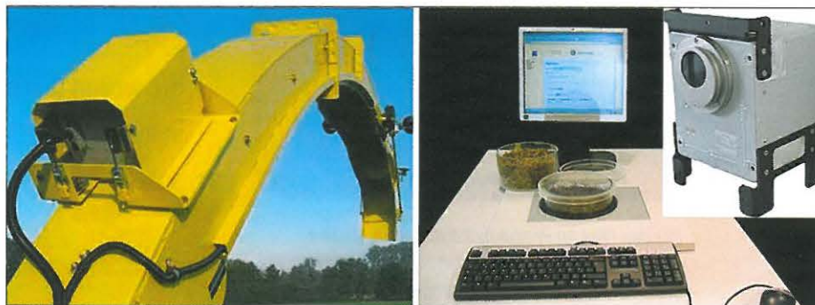
Bild 1: „HarvestLabTM“-Sensor im Aufbau auf einem Feldhäcksler und als stationäre Einheit
