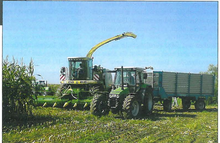
Inbetriebnahme eines Feldhäckslers mit elektrischem Einzugs- und Vorsatzantrieb auf dem Versuchsgut Hirschau
