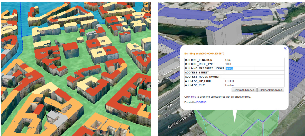
Abb. 1: Links: Virtuelles 3D-Stadtmodell von Berlin mit texturierten Gebäuden und Dacheinfärbungen bezüglich ihrer Eignungsklasse für Photovoltaikanlagen sowie farbigen Bezirksgrenzen als transparente Bodentextur, Rechts: Virtuelles 3D-Stadtmodell von London im Urzustand mit gewähltem (highlighted) Gebäude und Informationsballon.
