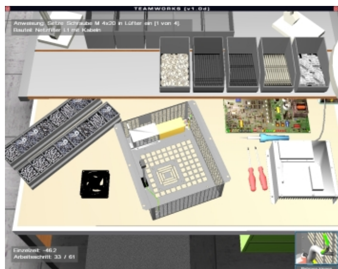
Abb. 9: Virtuelles Schulungstool für den Zusammenbau von elektronischen Baugruppen [fml]
