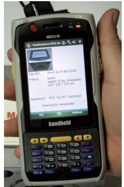
Die MobilAuthent-Lösung sieht neben der Nutzung stationärer RFID-Lesegeräte insbesondere auch den Einsatz mobiler Endgeräte vor (Quelle: MobilAuthent).
