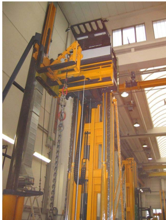
Abbildung 7: Versuchsaufbau zur Messung der Elastizität von Hubhydraulik und Hubketten
