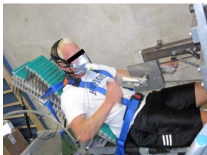
ABBILDUNG 24: VORTEST AUF DEM HANDKURBELERGOMETER MIT ERHEBUNG DER SPIROMETRISCHEN DATEN ZUR SPÄTEREN BESTIMMUNG DER INDIVIDUELLEN INTENSITÄTSBEREICHE. DEFINIERTE KURBEL- UND SITZEINSTELLUNGEN.
