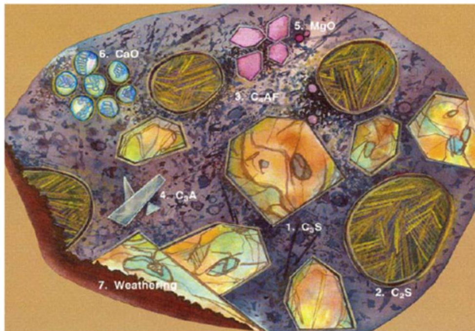
Abbildung 3: Mikroskopische Abbildung eines Portlandzementklinkers nach Anschliff und Färbung [57]
