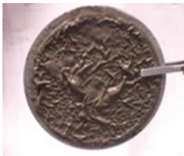
Abbildung 25: Polymerfilm zwischen dem Zementfilterkuchen und einem Edelstahlsieb nach Hochdruckfiltration (Differenzdruck 70 bar, Raumtemperatur) einer Zementschlämme mit einer Dosierung an Polyvinylalkohol von 0,5 % bwoc [215]
