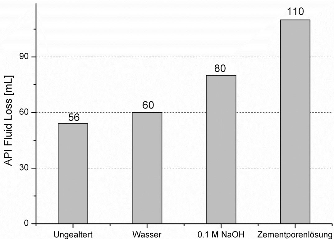
Abbildung 55: API Fluid Loss-Werte von Zementschlämmen ( w/z = 0,44 ) mit 0,4 % bwoc CaAMPS ® -co-NNDMA Fluid Loss Additiv vor und nach Alterung bei 200 °C und 35 bar in verschiedenen Medien (Wasser, 0,1 M NaOH, Zementporenlösung), gemessen bei 27 °C
