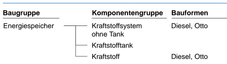
Abbildung 4.22: Gliederung der Baugruppe Energiespeicher in Komponentengruppen für ICEV
