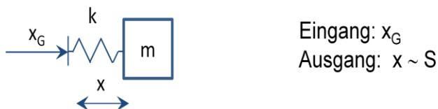
**Bild 11:** Einmassenschwinger mit Weganregung
