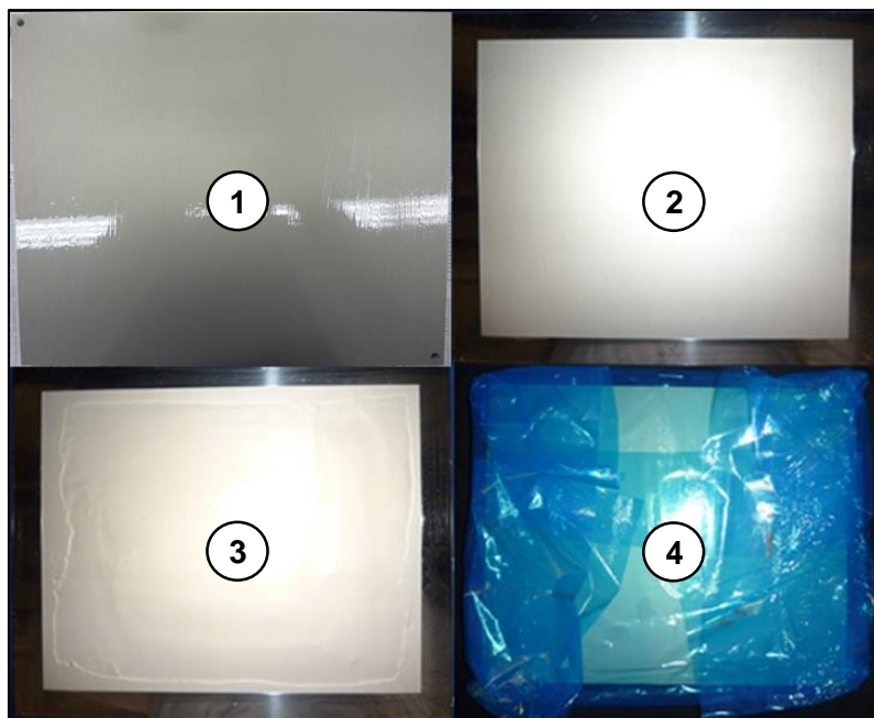
Abbildung 8.2: Einzelne Schritte während der Präparation zur Herstellung der Silikonmembranen (1) mit Spülmittelfilm beschichtete Formplatte; (2) beschichtete Formplatte mit beschichtetem Formrahmen; (3) aufgetragenes Silikongemisch auf der Innenseite der Formplatte; (4) Packung der Formplatten in hitzestabiler Folie
