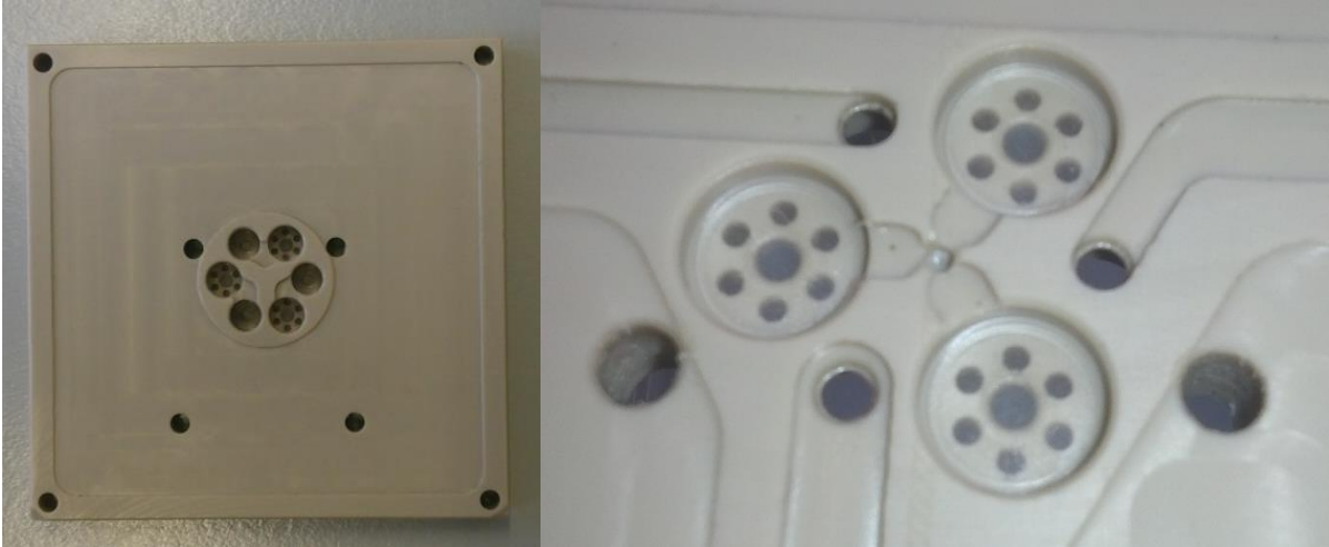
Abbildung 8.7: Neuer Prototyp mit drei Pumpkammern mit Lippenrückschlag- und Schirmventilen
