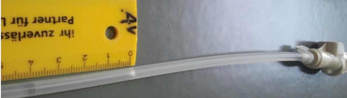
Abbildung 8.3: Polypropylen Schnellkupplung (Timmer-Pneumatik GmbH, Neuenkirchen) mit Luftblase nach dem Ankuppeln
