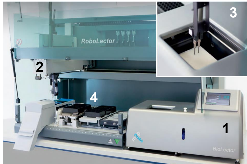
Abbildung 3.6: RoboLector mit in einen Laborrobotersystem (Tecan) integrierter BioLector Inkubationseinheit (1). Über eine Öffnung kann ein Pipettierarm (2) die Reaktionskammern des Mikrotiterplatten basierenden Systems (3) mit Flüssigkeiten versorgen. Hierfür stehen auf der Arbeitsfläche des Laborrobotersystems mehrere Vorlagebehälter zur Verfügung (4).
