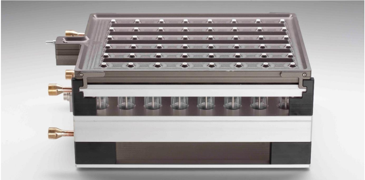
Abbildung 4.1: Mit Einwegreaktoren bestückter Bioreaktorblock mit aufgesetzter Begasungshaube. An der Kopfseite des Bioreaktorblocks befinden sich die Anschlüsse für die zwei Wärmetauscher zur Temperierung der Reaktoren und des Kopfraumes. Am unteren Wärmetauscher befindet sich zudem der Anschluss für die Spannungsversorgung und Steuerung des integrierten magnetisch-induktiven Rührerantriebs. Die Begasungshaube besitzt Anschlüsse für die Gasversorgung, sowie den Ablauf von gegebenenfalls auftretendem Kondenswasser. 48 mit Teflonbuchsen versehene Öffnungen in der Begasungshaube erlauben Abgas auszutreten und die Probenahme oder auch Flüssigkeitsdosierung.
