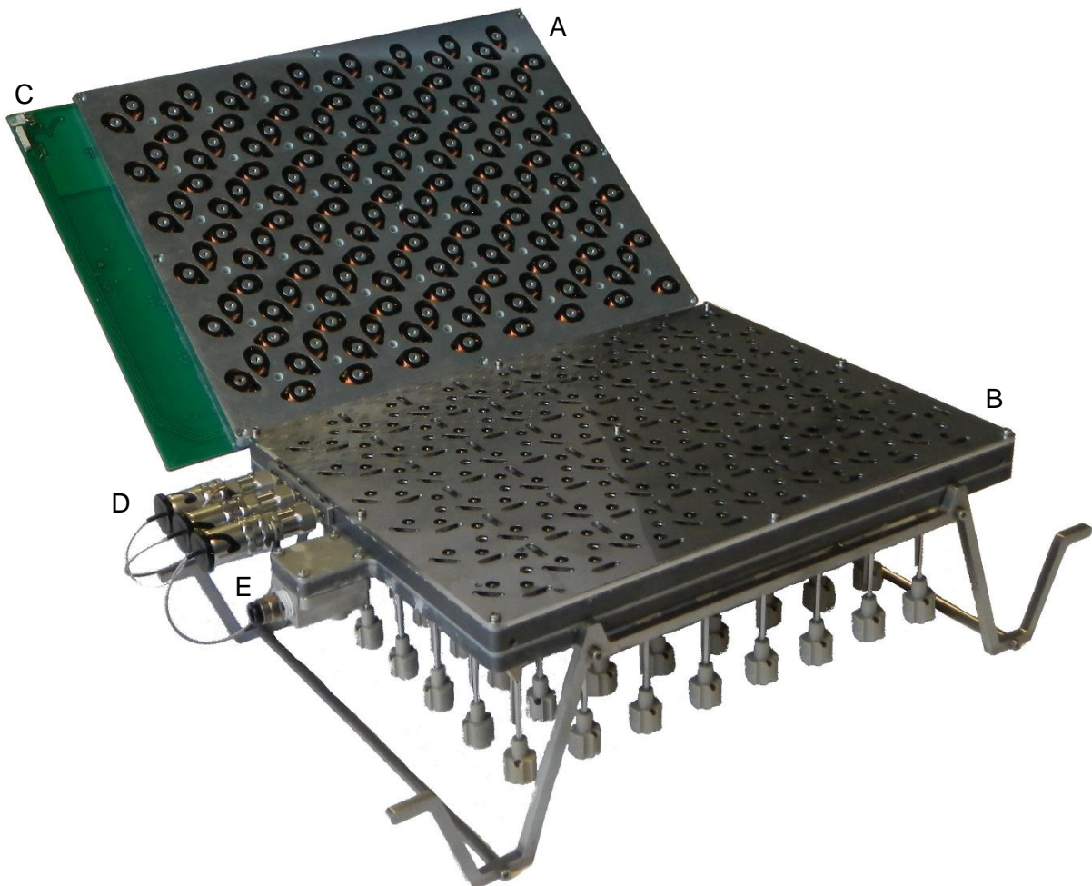
Abbildung 4.14 Zweiteiliger Aufbau der Mikrodosiereinheit mit abnehmbarer Steuereinheit (A) und autoklavierbarer Fluidikeinheit (B). Kopfseitig befinden sich die Anschlüsse für die Datenschnittstelle und Spannungsversorgung mit LED (C), die drei Fluidkanäle (D) und die Gasversorgung (E).
