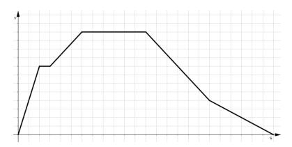
Abbildung 2: Geschwindigkeitsprofil eines Zuges - Geschwindigkeit v in Abhängigkeit der Stationierung s
