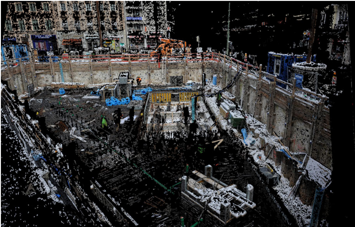
Abbildung 2.1: Punktwolke der Projektbaustelle in der Bauphase. Quelle: Sebastian Tuttas
