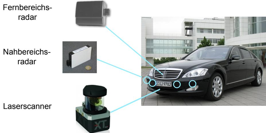
Abbildung 2.6: Verbaupositionen der Sensoren im Versuchsträger
