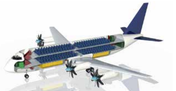
Das Propeller-getriebene Flugzeug bietet auf zwei Decks Platz für etwa 400 Passagiere.
