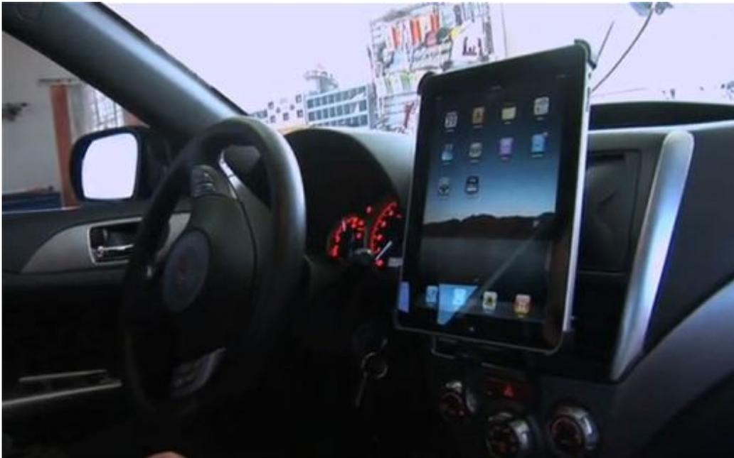
**Abbildung 2-2: Kfz Tablet Halterung**
