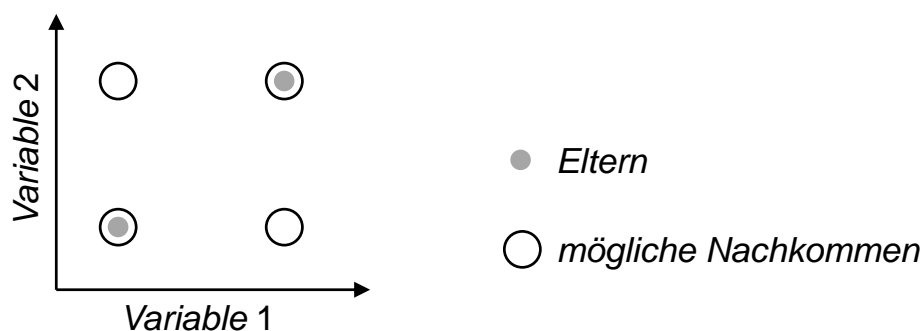
Abbildung 2-17: Schema der diskreten Kombination am Beispiel von zwei Eltern (nach POHLHEIM 1999, S. 35)
