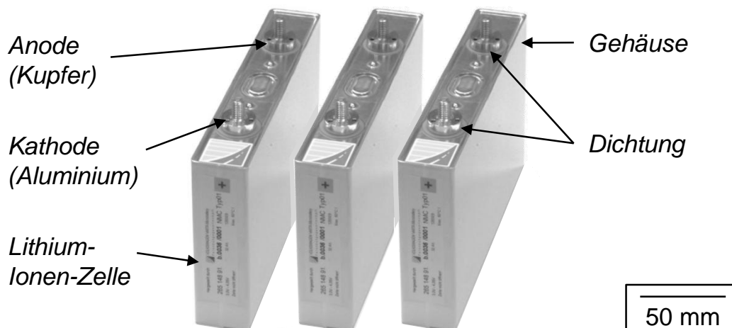
Abbildung 2-4: Aufbau einer prismatischen Lithium-Ionen-Zelle für den Einsatz in Elektrofahrzeugen mit einer Kapazität von 30 bis 38 Ah (nach POMPETZKI 2013)
