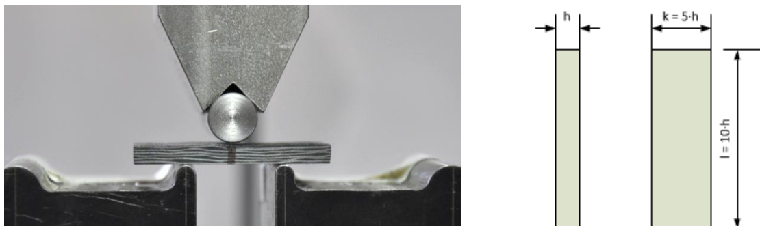
Abbildung 2.12: Links: Prüfaufbau mit zwei Auflagern (unten) und Druckfinne (oben) zur Bestimmung der ILSS; rechts: Probengeometrie in Seiten- und Vorderansicht
