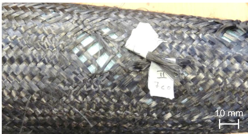
Abbildung 5.12: Durch das Einbringen der zusätzlichen Fäden verursachten Lücken im Geflecht
