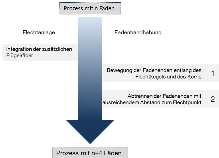
Abbildung 5.16: Prozessschritte bei der Einbringung von Fäden
