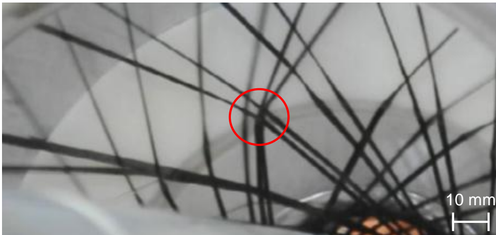
Abbildung 4.7: Behinderung der sich kreuzenden Fäden am Flechtring
