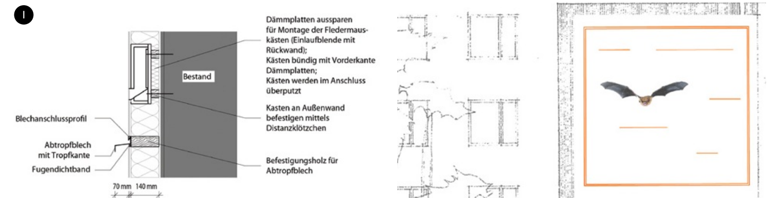
Schnitt Fassadenquartier: Quelle: Architekturbüro Hechenbichler, München
