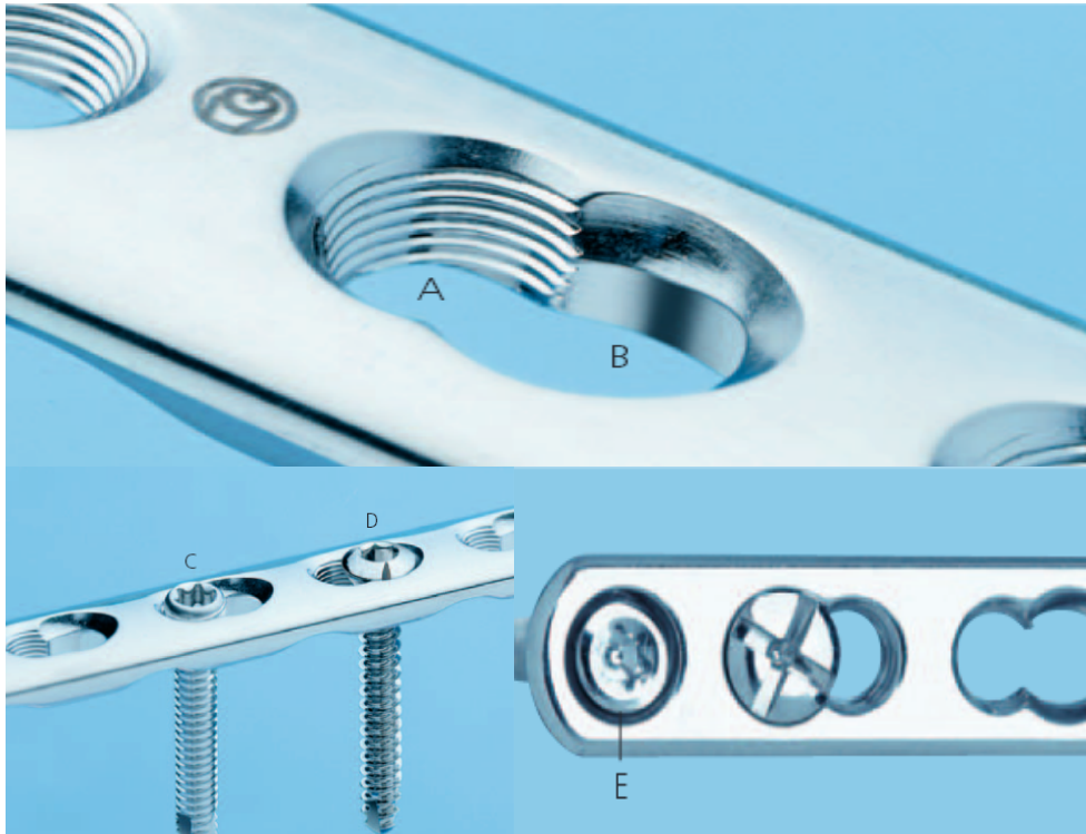
Abbildung 12: LCP-System, A: Gewindeträger Teil für Verriegelungsschrauben, B: DCU-Teil für Standardschrauben, C: Verriegelungsschraube im gewindeträger Teil des Kombilochs, D: Kortikalisschraube im DCU-Teil des Kombilochs, E: Kombirundloch am Ende des Plattenschafts für Kortikalisschrauben oder Verriegelungsschrauben. (Synthes Anwenderbroschüre)
