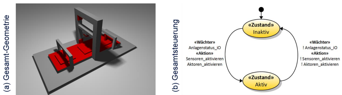
Abbildung 53: Gesamtgeometrie und Gesamtsteuerung des Bedruckungsmoduls
