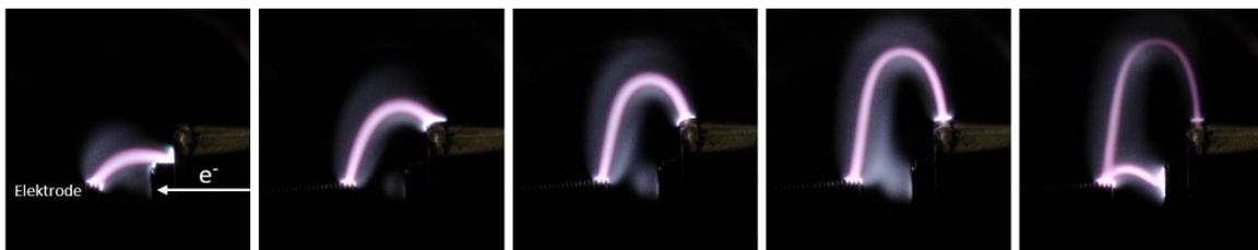
**Abbildung 67** Fotoserie der Entladung in 1 bar Argon bei horizontal liegenden Elektroden. Die Serie stellt eine zeitliche Abfolge verschiedener Entladungszustände dar. Nach der Zündung im linken Bild wandert der Entladungskanal nach oben. Im rechten Bild ist oben noch der Rest des ersten Entladungskanals zu sehen sowie auch schon ein neu gezündeter.
