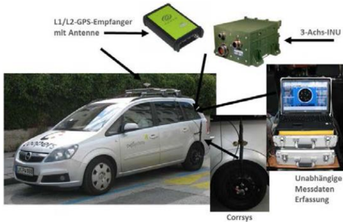
Abbildung 13: Concept-Car, Navigations-Ausrüstung zur Vermessung der Fahrstreifen
