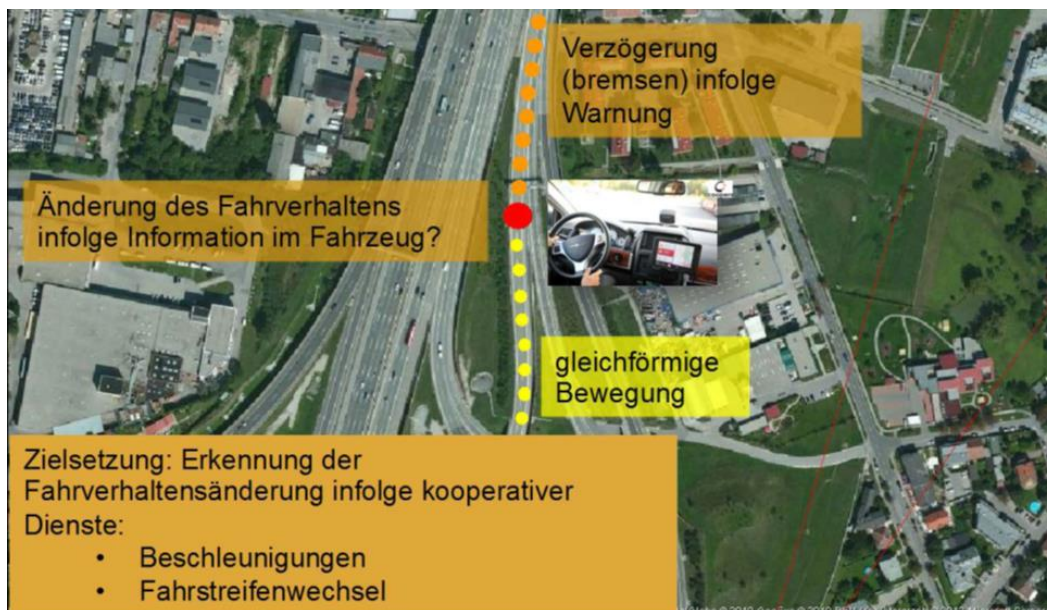
Abbildung 2: Grundsätzliches Vorgehen zur Wirkungsermittlung von Informationen aus Einzelfahrzeugpositionen basierend auf GPS-Daten
