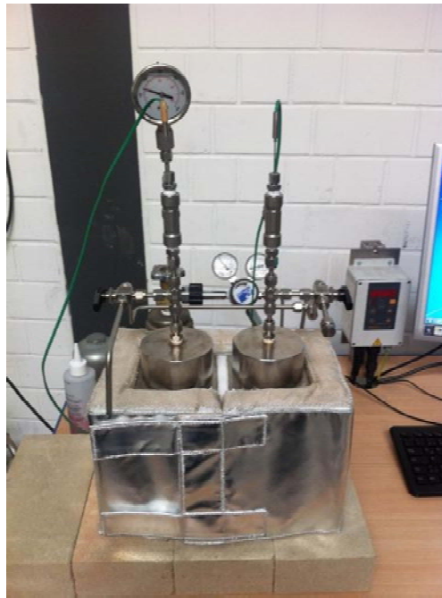
Abb. 40: Aufbau der Laboranlage zur Differentiellen Temperaturanalyse
