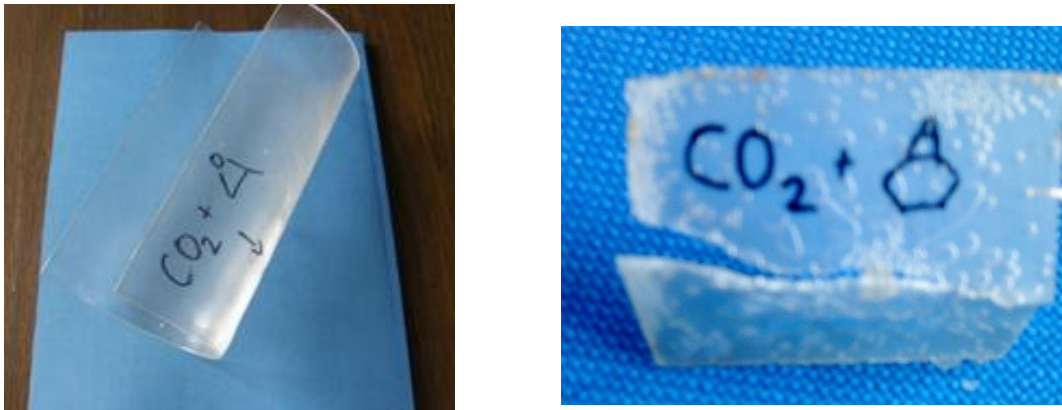
Abbildung 4: Poly(propylencarbonat) (links) und Poly(cyclohexencarbonat) (rechts)
