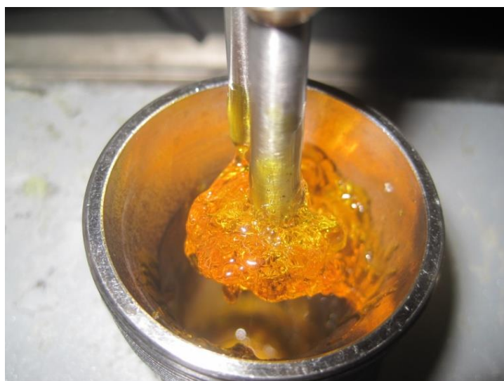
Abbildung 31: CHO/CO 2 -Copolymerisation mit Komplex 2 nach 1,5 min mit den Bedingungen aus Versuch 8
