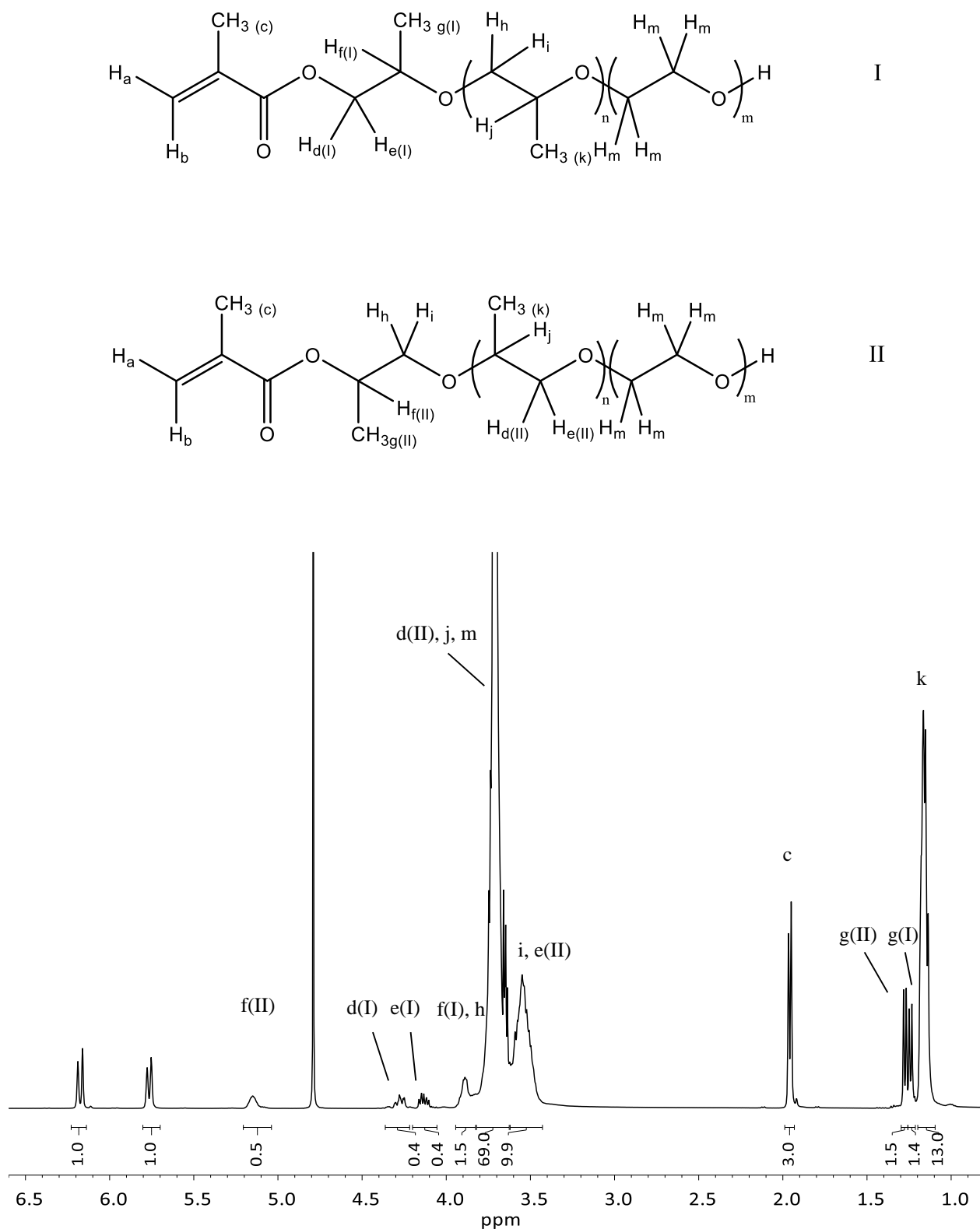
Abbildung 34: Darstellung zweier Isomere von PEG MA 1000 und zugehöriges ^1H NMR-Spektrum, aufgenommen in D_2O .
