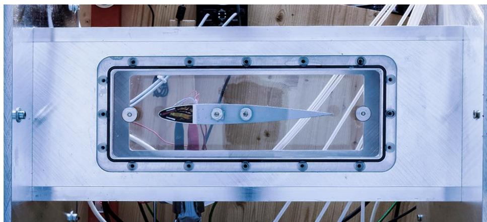
Abbildung 7.2 In der Testsektion des Windkanals bei einer  $0^\circ$  Anstellwinkelkonfiguration eingebautes NACA 0012 Flügelprofil mit dem im Bereich der Vorderkante integrierten hybriden Systemansatz.
