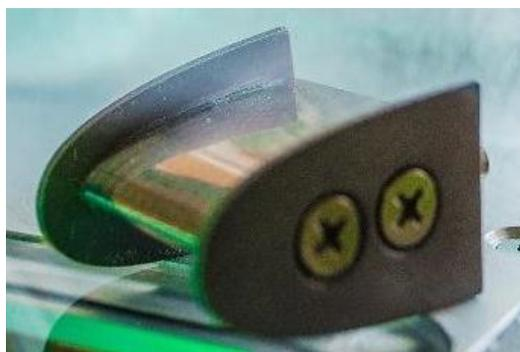
Abbildung 3.8 Glatte Aluminiumoberfläche des Probenkörpers mit  $R_a = 110 \pm 8 \text{ nm}$  [114] sowie seitlich am Probenkörper befestigte Trennscheiben aus PVC.
