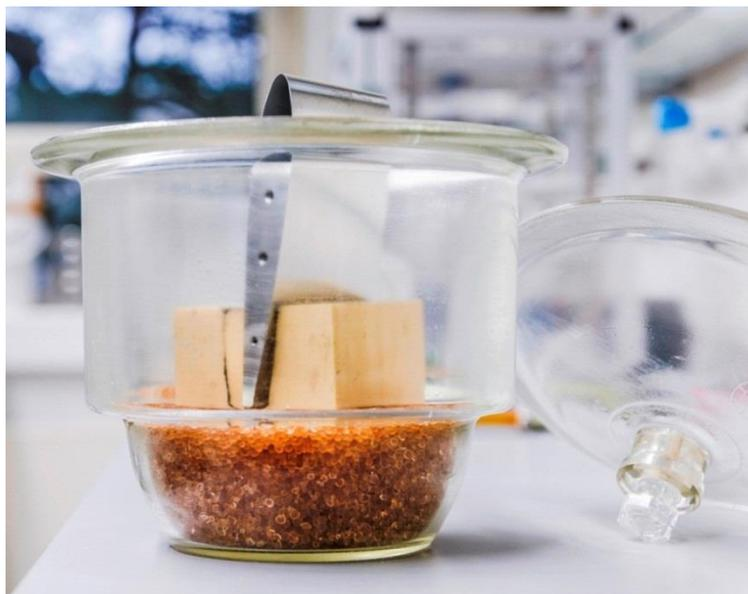
Abbildung 3.12 Hydrophobierung des *NACA 0012* Flügelprofils in einem Exsikkator zur Herstellung der eisphoben Eigenschaften der glatten, nanostrukturierten Oberfläche im Bereich der Flügelvorderkante.
