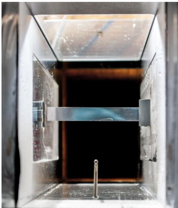
Abbildung 3.21 Darstellung eines innerhalb der Testsektion des Vereisungswindkanals positionierten Probenkörpers. Der Blick auf den Probenkörper erfolgt in Richtung der Strömung. Die Prandtl-Sonde zur Messung der Strömungsgeschwindigkeit und Totaltemperatur während des Vereisungsvorgangs ist unten dargestellt [170].
