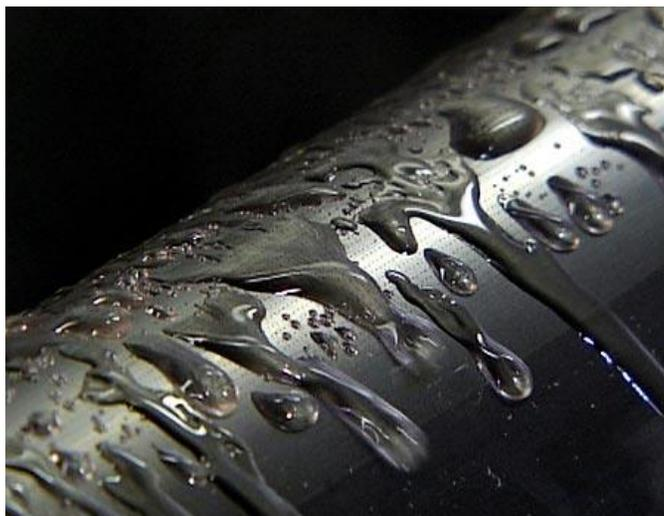
Abbildung 2.13 Poröse Oberfläche eines Flüssigkeitsenteisungssystems auf Basis gefrierpunktsenkender Chemikalien [143].
