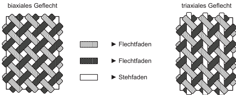
Abb. 3: Biaxiales Geflecht und triaxiales Geflecht
