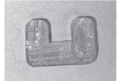
Abb. 3: U-förmiges Agarosestück zur Stabilisierung der Gewebeprobe während des Schneidevorgangs.
