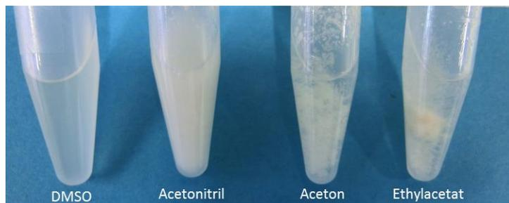
**Abb. 5.7:** Löslichkeitsversuche der Fermentationsproben in verschiedenen Lösungsmitteln. Untersucht wurde die Löslichkeit des Niederschlags in DMSO, Acetonitril, Aceton und Ethylacetat. Die Proben wurden sechsfach mit dem entsprechenden Lösungsmittel verdünnt. Wie zu erkennen ist, löst sich die Probe vollständig in DMSO und unzureichend in den anderen Lösungsmitteln.
