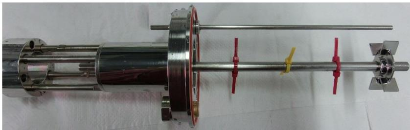
**Abb. 5.3:** *Rührwerk eines DASGIP-Fermenters mit mechanischen Schaumbrechern aus Kabelbindern nach [84]. Diese einfache Maßnahme trug zu reproduzierbaren Wachstumsphasen des Bio-transformationsprozesses bei.*
