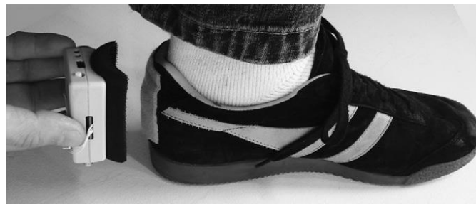
Abbildung 3-10: Das S-Sense Modul ist an dem Schuh mit einem Klettverschluss befestigt, entnommen aus (Mariani et al. , 2010).
