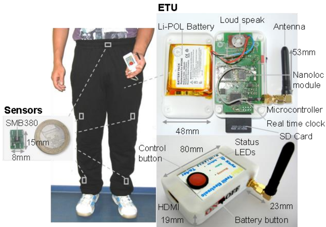
Abbildung 6-1: Aufbau der MiMed-Hose: Beschleunigungssensoren und die Elektronik, entnommen aus (Zhao et al. , 2012).
