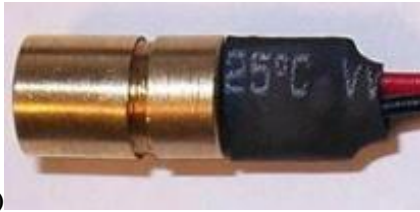
Abbildung 6-9 (a) Linienlaser mit integrierter Elektronikeinheit der Firma Picotronic GmbH, (b) Folientaster FT01M (Bestell-Nr. bei Conrad: 701838 - 62)
