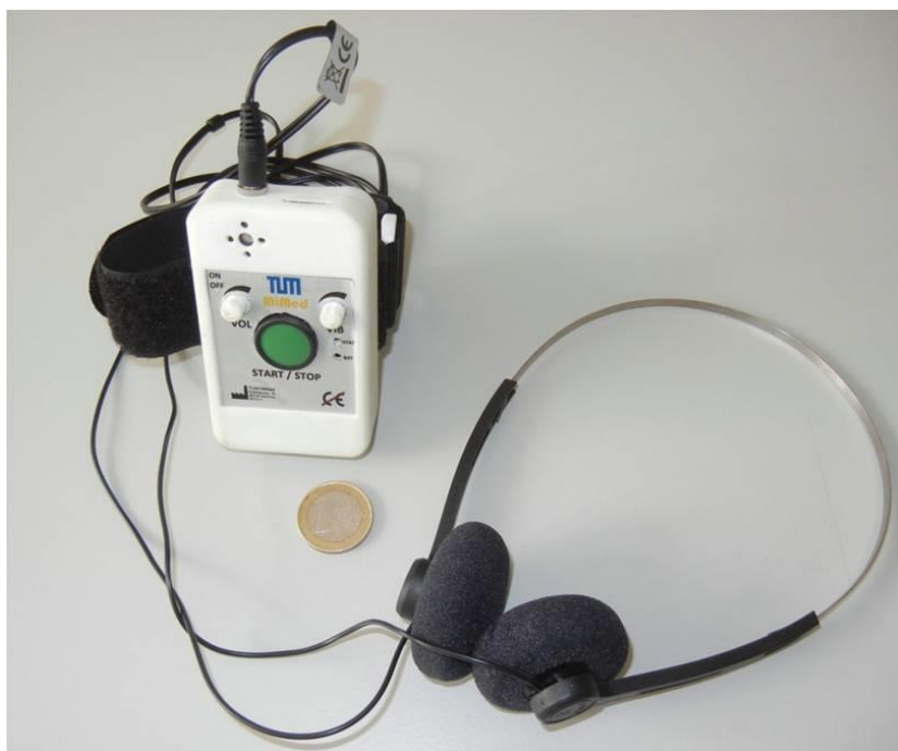
Abbildung 6-18: Die MuCU bietet dem Verwender akustisches Cueing entweder über Lautsprecher oder über Kopfhörer – Zum Größenvergleich dient eine 1 Euro Münze.
