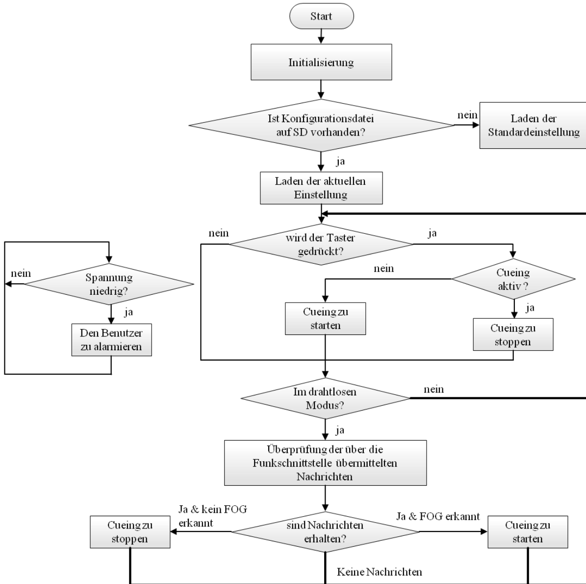
Abbildung 5-26: Vereinfachtes Flussdiagramm des Hauptprogrammes im Mikrocontroller.
