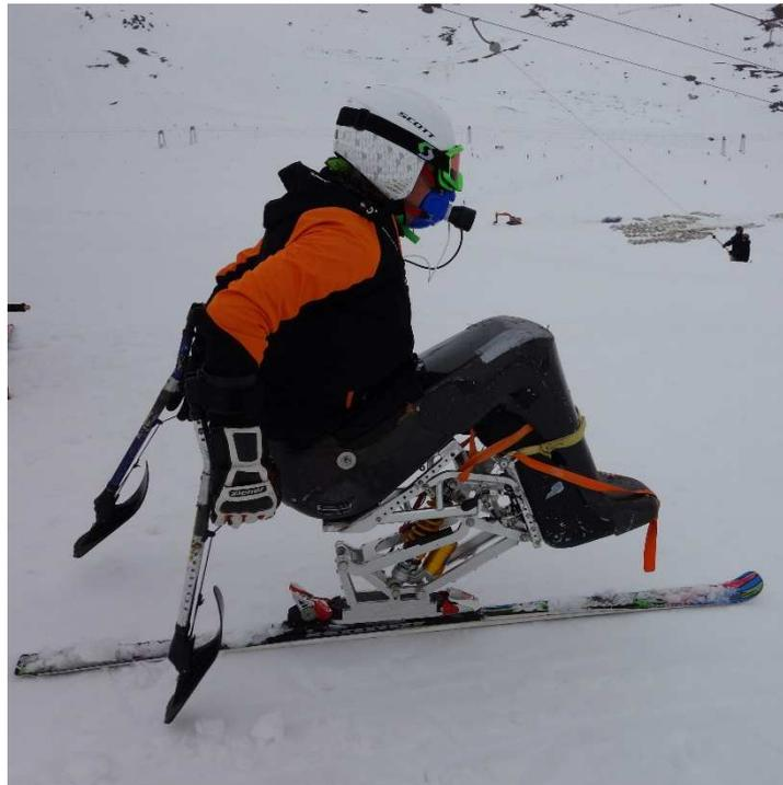
Abbildung 1 Monoskigerät, Feder- und Dämpfersystem (roter Kasten) und Athlet in Monoski mit Krückenski
