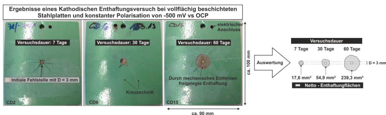
Bild 4-22: Beispielhafte Enthaftungsergebnisse in künstlicher Betonporenlösung und deren Auswertung an drei epoxidharzbeschichteten Stahlplatten (7d, 30d, 60d)
