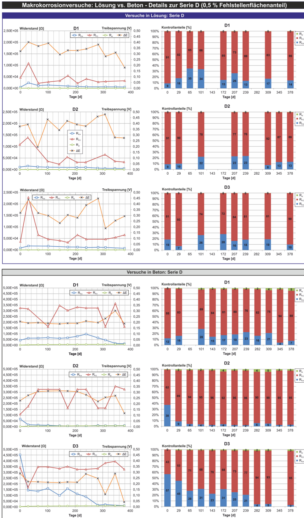
Bild A-15: Details ermittelter Modellparameter sowie Einzelwerte der Kontrollanteile für die Serie D in Lösung (oben) und in Beton (unten)
