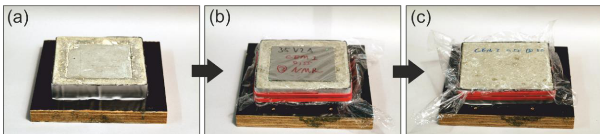
Bild 6-3: Prozedere zur Integration einer epoxidharzbeschichteten Edelstahlplatte in den Betonprobekörper zur zyklischen Entnahme und Einlagerung (vergleiche Bild 6-2)
