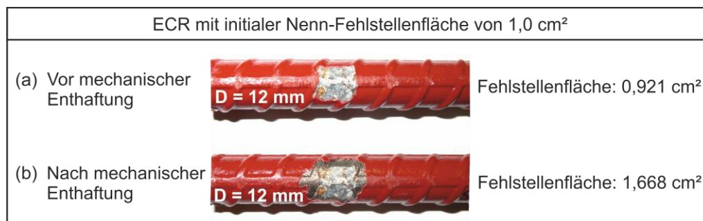
Bild 10-7: Beispielhaftes visuelles Erscheinungsbild eines isolierten ECR-Stabs mit einer künstlich eingebrachten Fehlstelle von 1,0 cm 2 (hier Bohrkern 557, Seite Thun)
