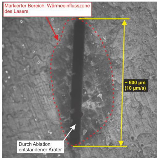
Bild 7-5: Mikroskopaufnahme (Draufsicht) eines Linienscans des Lasers an einer Beschichtungsprobe
