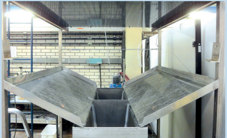
Bild 2. Versuchsaufbau für Rinnensysteme – Ansicht der Beregnungsanlage, der beiden Edelstahlbleche sowie in der Mitte unten die beiden hintereinander angeordneten Rinnenkörper (Doppelbestimmung).
