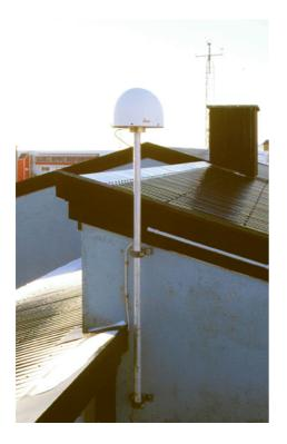
Abb. D8.1 GPS-Antenne mit Radom an der neuen Permanentstation in Tórshavn
