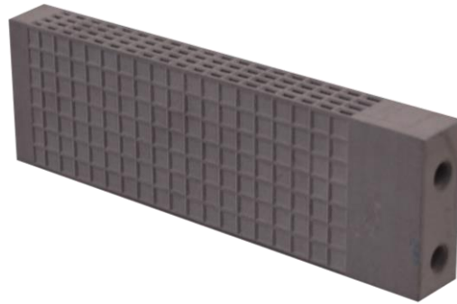
Abbildung 7-13: Regelmäßige Gitterstruktur mit Schubfeldern
