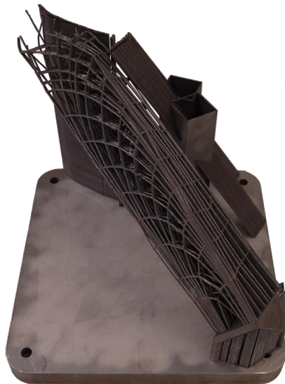
Abbildung 9-1: Mehrmaliger Abbruch des Baujobs aufgrund Prozessinstabilität
