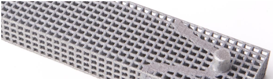
Abbildung 1-4: Leichtbau durch den Einsatz additiv gefertigter Gitterstrukturen
