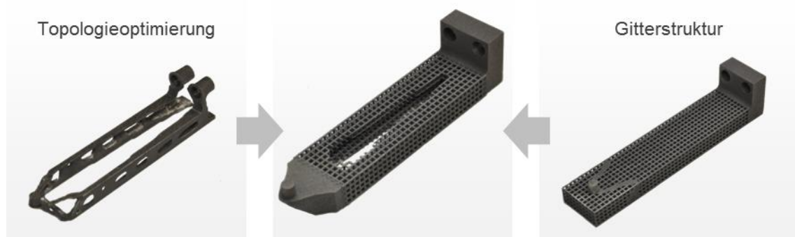
Abbildung 3-11: Kombination aus einer Topologieoptimierung und dem Einsatz einer Gitterstruktur zur Verbesserung des Leichtbauverhaltens, in Anlehnung an (REINHART ET AL. 2010)
