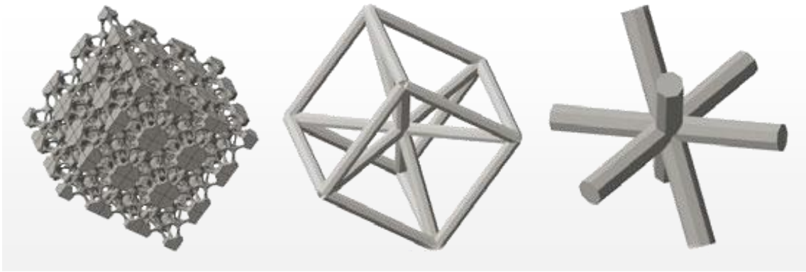
Abbildung 3-7: Beispielhafte Elementarzellen aus einer kommerziell erhältlichen Software, in Anlehnung an (BREUNINGER ET AL. 2013)
