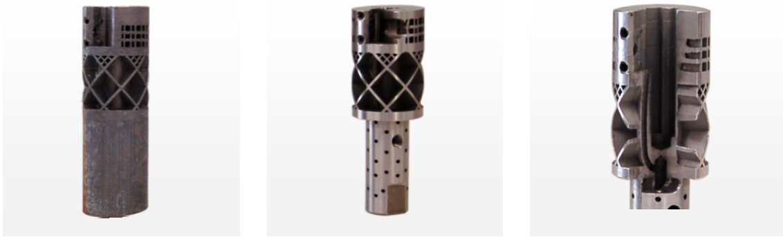
Abbildung 8-6: Additive Fertigung der Außenreibahle links: Außenreibahle nach der additiven Fertigung Mitte: Fertigbearbeitete und montierte Reibahle rechts: Schnitt durch den Kühlschmierstoffkanal
