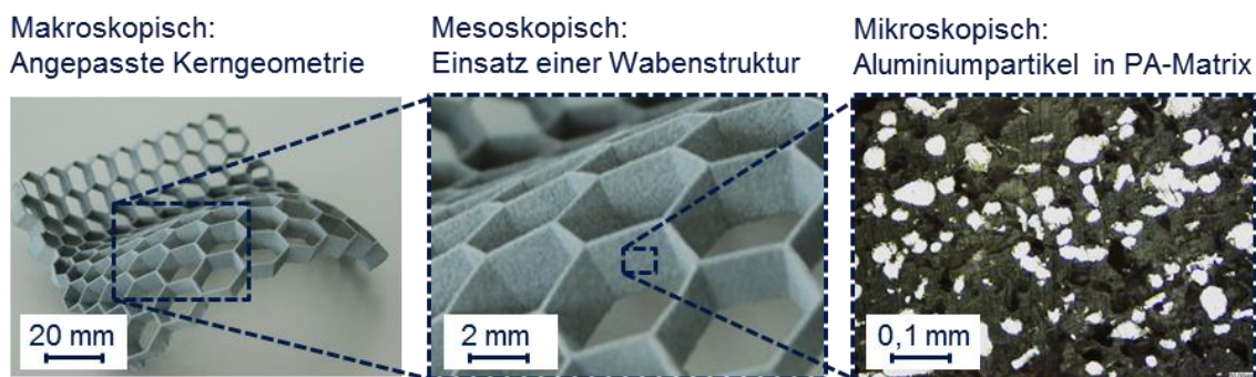
Abbildung 2-2: Unterteilung des Formleichtbaus am Beispiel eines Wabenkerns für ein Sandwichbauteil (Bild links: OTT ET AL. 2013)
