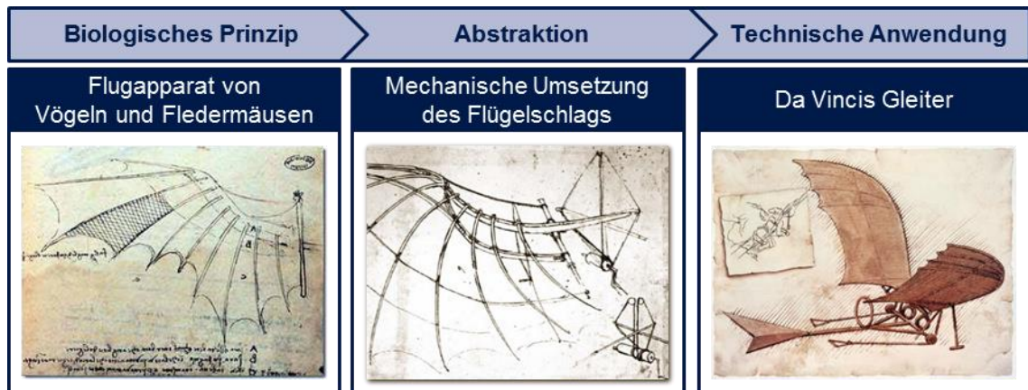
Abbildung 2-9: Da Vincis Gleiter als Beispiel für eine frühe bionische Entwicklung nach dem Vorbild des Flugapparats von Vögeln und Fledermäusen (Bildquelle: GELB 2000)
