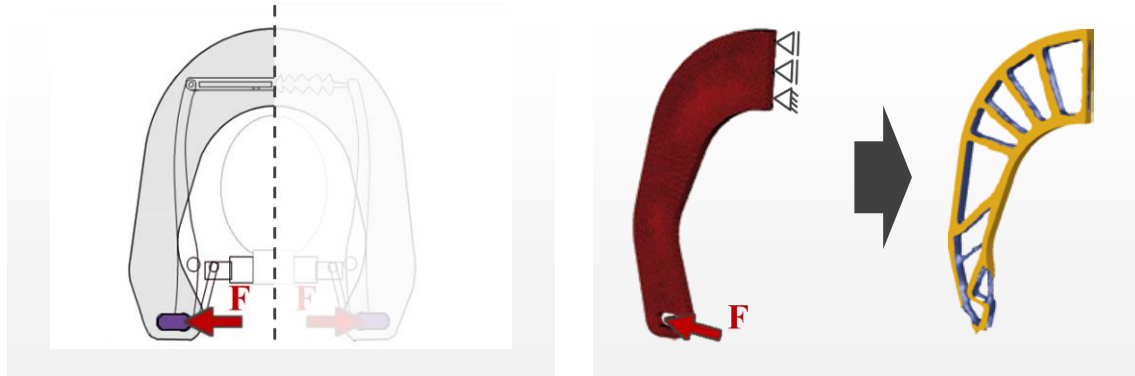
Abbildung 3-18: Beispiel für eine Topologieoptimierung, in Anlehnung an (ALBERS ET AL. 2011)
