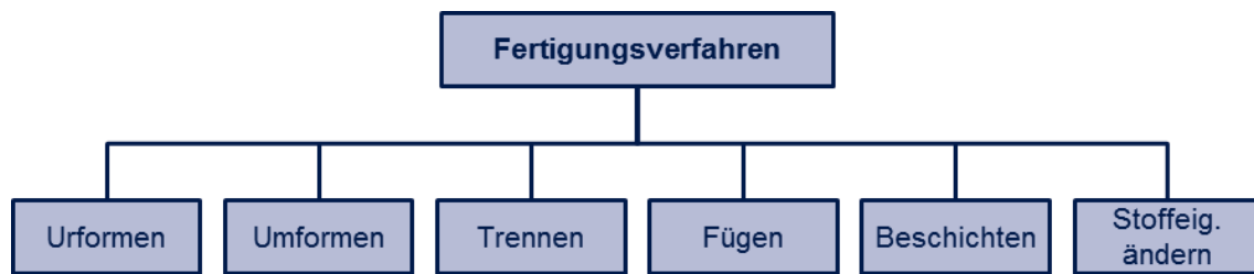
Abbildung 2-3: Einteilung konventioneller Fertigungsverfahren nach DIN 8580
