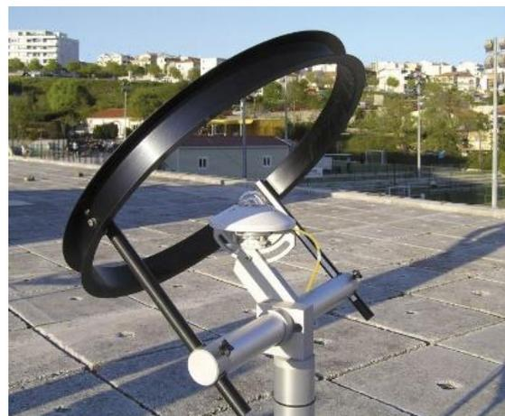
Abbildung 7 Pyranometer CM21 der Firma Kipp & Zonen mit Schattenring zur Messung der Diffusstrahlung (Gengenbach Messtechnik e.K 2015)
