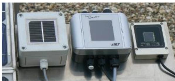
Abbildung 4 Siliziumzellensensoren (Mertens 2011)
