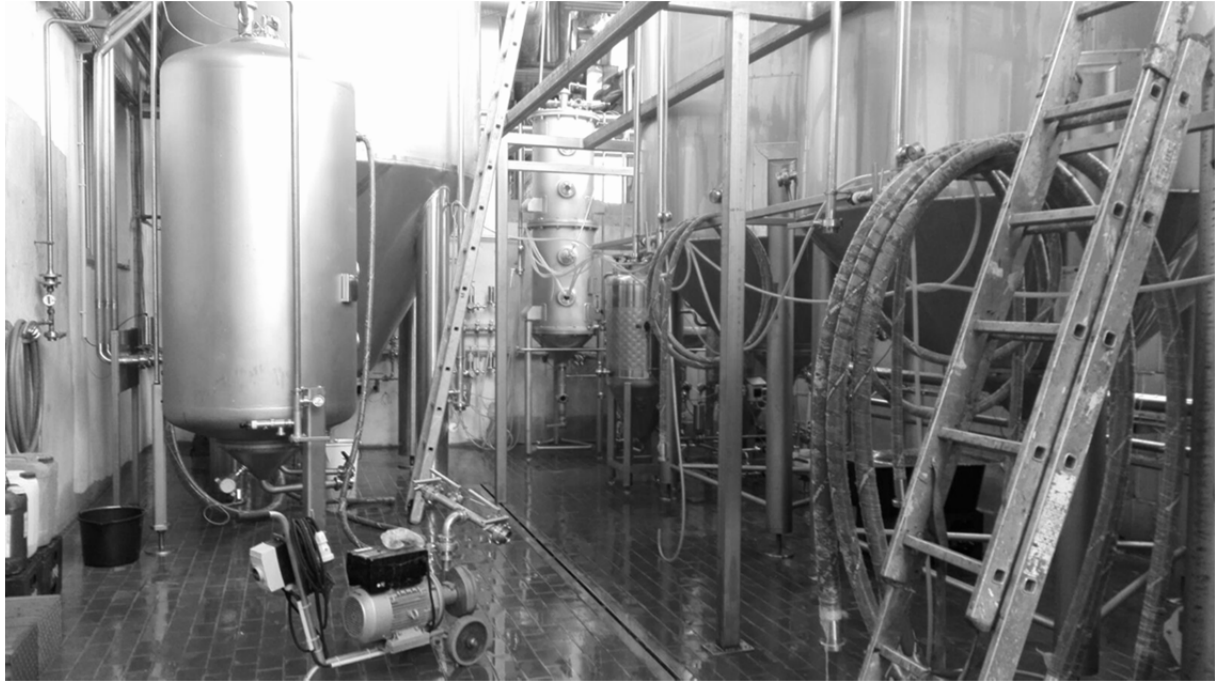
Abb. 78: Industrielle Versuchsanlage zur kontinuierlichen Fermentation
