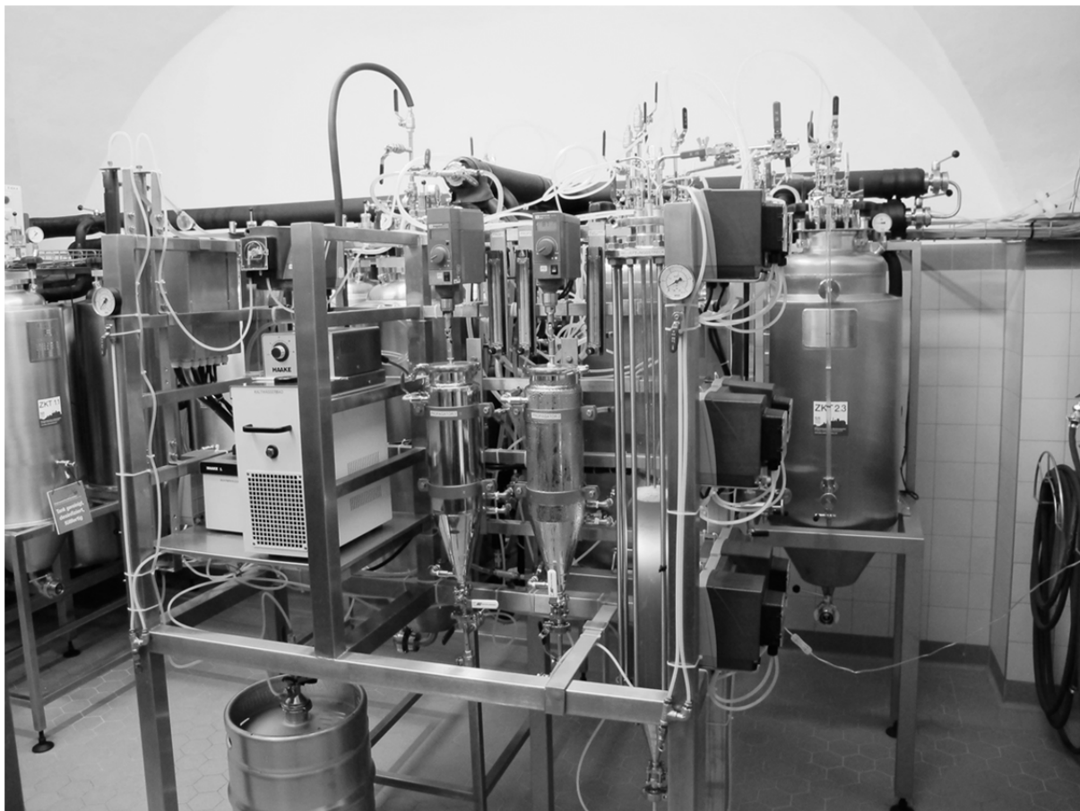
Abb. 42: Foto der Pilotanlage zur kontinuierlichen Fermentation
