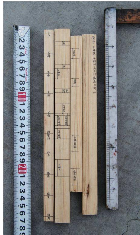
Abb. 7 Modell des für den Bau der Dongtang-Brücke verwendeter Maßlatte, Maßstab 1:10, mit Markierungen auf drei Seiten (auf der vierten Seite des Modells befinden sich Informationen zum Brückenbau). Angefertigt durch den Autor während des Projekts im Dez. 2013.
