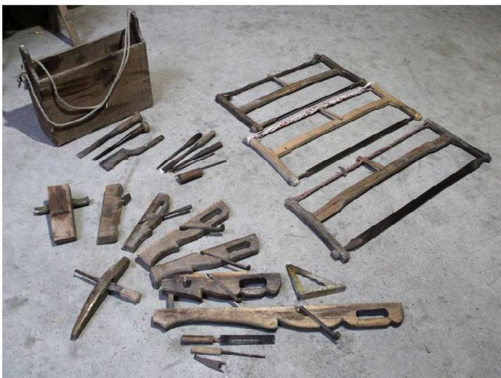
Abb. 15 Typische Werkzeuge eines Zimmermanns. Hexi, Landkreis Zhouning, Fujian: Bohrer, Hobel, Stemmeisen, Winkel und Sägen.
