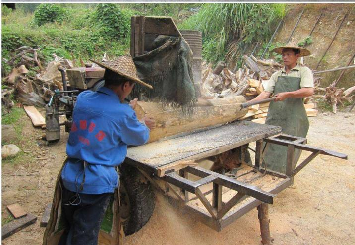
Abb. 16 Baustelle der Sheshuitang-Brücke, Landkreis Qingyuan, Zhejiang. Der zur Bandsäge umgestaltete Traktor.
