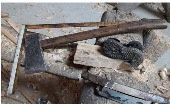
Abb. 4 Baustelle der Dongtang-Brücke. Landkreis Jingning, Zhejiang. Lubanswinkel, Axt und Tintenschnur.
