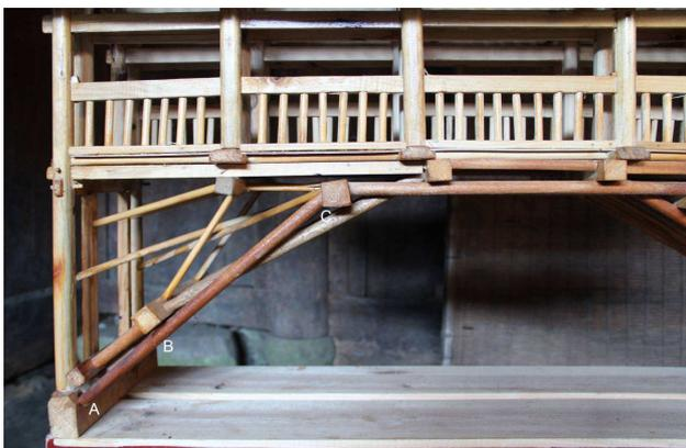
Abb. 28 Brückenmodell von Meister Zheng Duoxiong. Der U-Q-Balken(2) ist sehr niedrig (der U-S-Balken sehr kurz).
