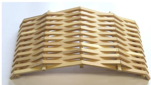
Abb. 5 Modell der Regenbogenbrücke mit vierkantigen Balken. Gefertigt durch diesen Autor.
