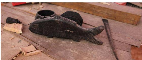
Abb. 10 Baustelle einer Holzbogenbrücke in Ganzhushan, Landkreis Qingyuan, Zhejiang. Nov. 2013. Eine Tintenschlagschnur und ein Bambusstift.
