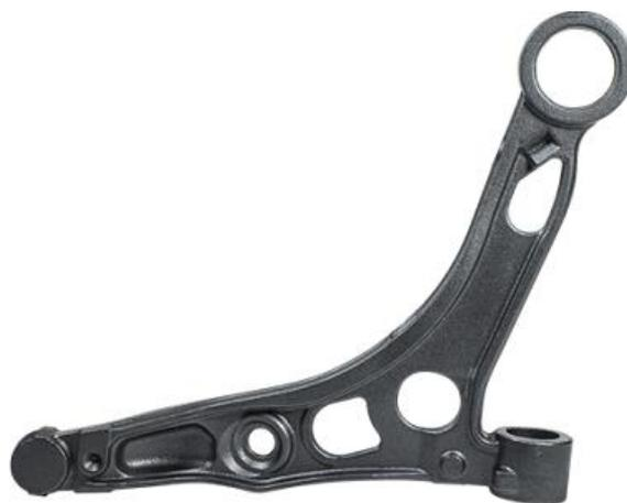
Abbildung 1.1: *Querlenker aus ADI. Die Zugfestigkeit wird vom Hersteller mit 900 MPa und die erreichbare Dehnung mit 8 % angegeben.<sup>1</sup>*
