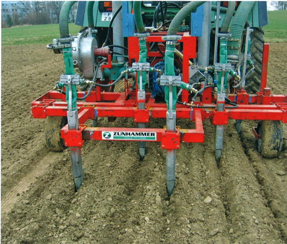
Abb. 1: Injektion der Gülle circa 10 cm tief in den Boden. Zwischen zwei Güllebändern steht später der Mais
