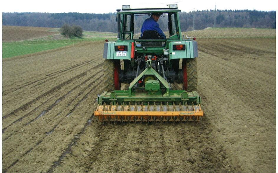
Abb. 2: Bandförmige Ablage der Gülle, die anschließend flächig in den Boden eingearbeitet wird
