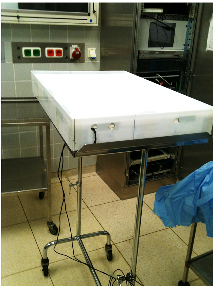
Abbildung 10 / RFID-Antennen (OBID i-scan, 13.56 MHz; FEIG Electronic GmbH, Weilburg, Deutschland) Zu erkennen ist hier der Instrumentiertisch der Operationsschwester, auf dem die RFID-Antennen angebracht sind. Diese sind in ein Gehäuse eingebaut, welches einerseits Schutz der Elektronik und andererseits der leichten Desinfektion der Arbeitsfläche dient. Für den Eingriff wurde der Tisch steril bezogen.
